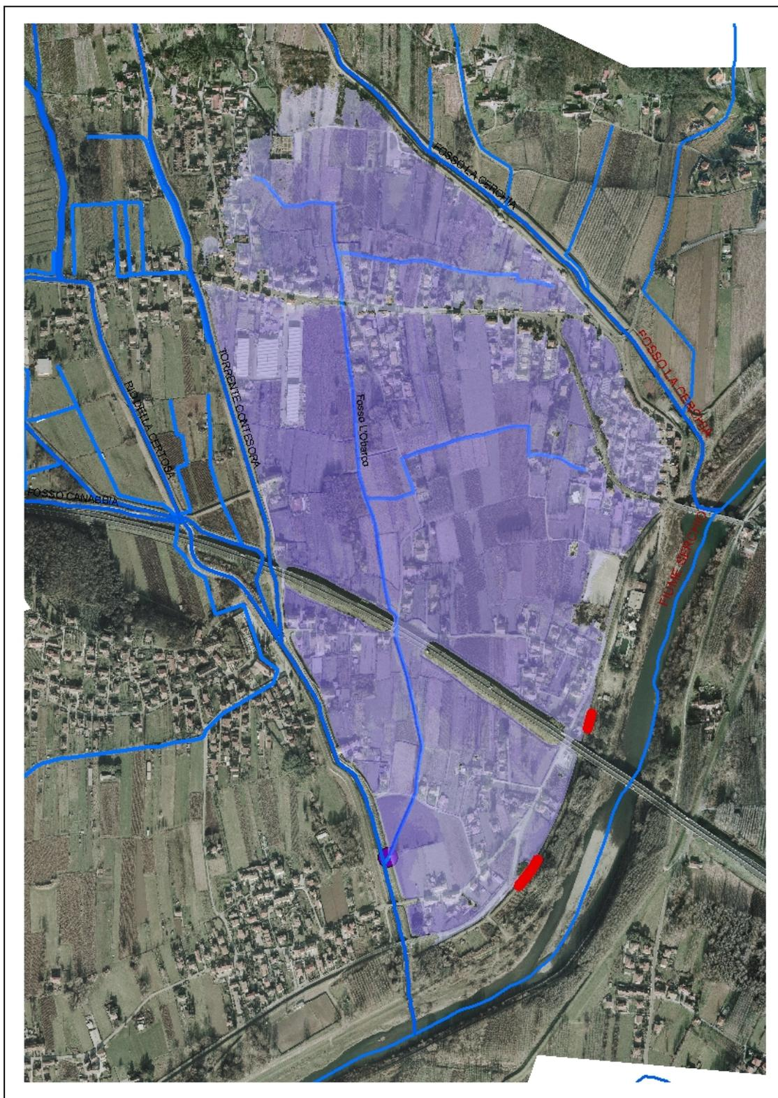
Fig. 11 - Ortofoto dell'area di Santa Maria a Colle con l'individuazione delle aree allagate.
