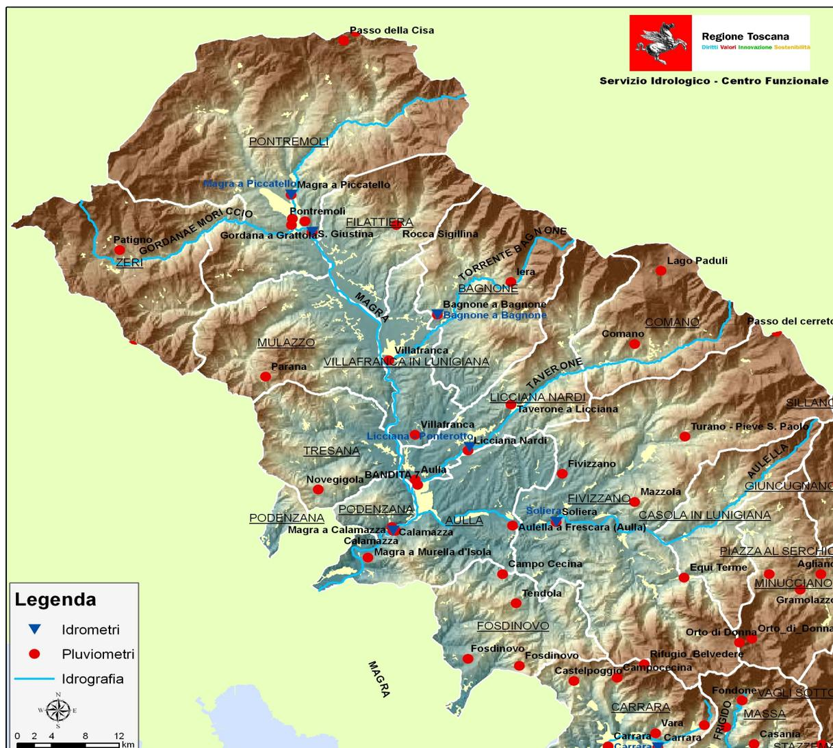
Fig.6 : distribuzione delle stazioni idropluviometriche nel Bacino del Fiume Magra. In rosso sono visualizzati i pluviometri per la misura della pioggia, in blu gli idrometri per la misura del livello idrometrico del fiume.
