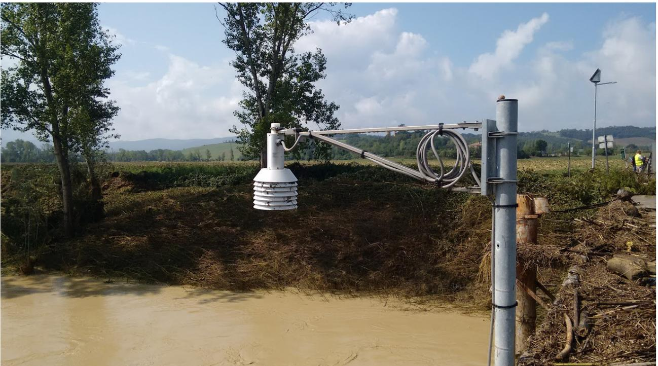
*Ombrone Gr a Buonconvento: particolare del sensore ad ultrasuoni*
